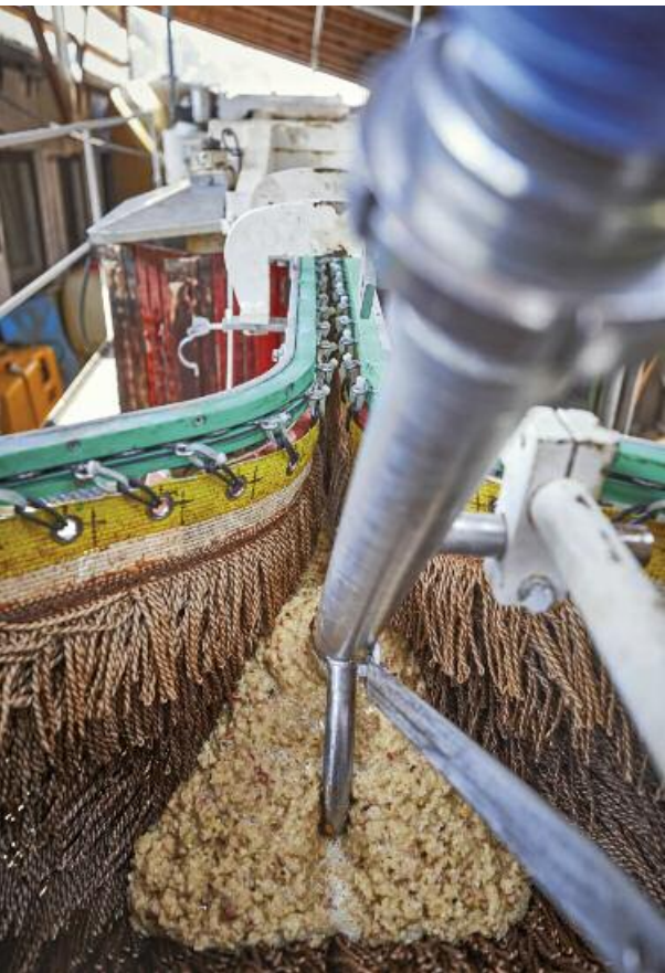
Die Apfelmaische wird in die Saftpresse gefüllt.
